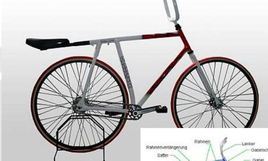
Hinterrad kannst du vorwärts- aber auch rückwärts fahren. Der hochgestellte Lenker bietet dir die Möglichkeiten, den Ball mit dem Vorderrad zu schießen. Durch die waagrecht angebrachte Sattelstange hast du mehr Bewegungsfreiheit und kannst besser das Gleichgewicht halten. Leider ist das Rad recht teuer und hält bei der starken Beanspruchung oft nur eine Saison.
